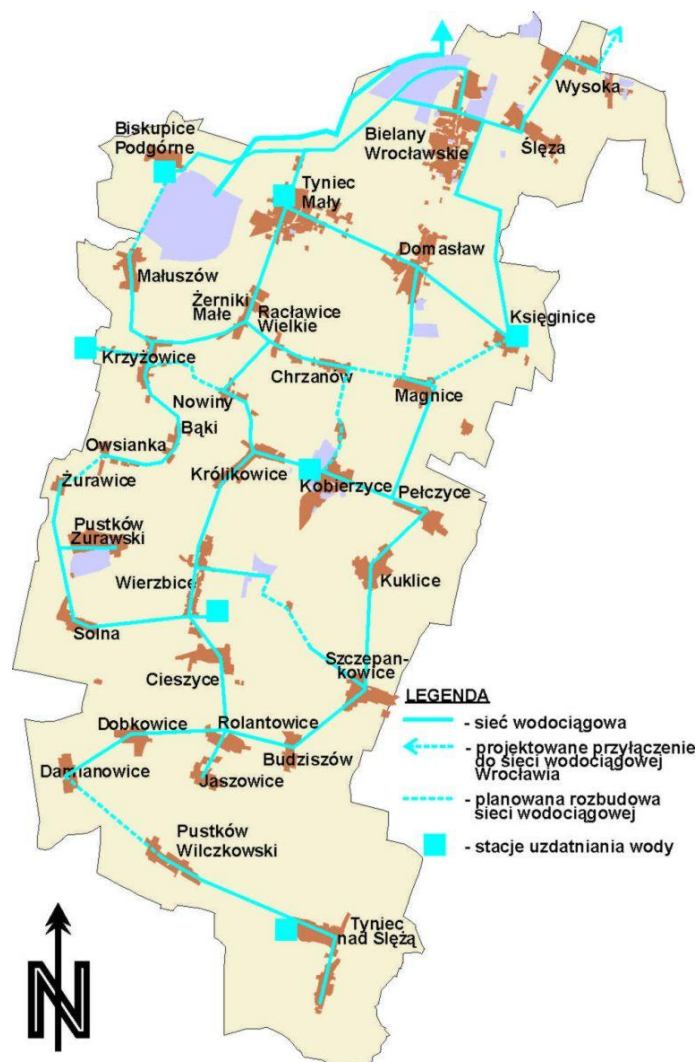
Rys. 5-4 Sieć wodociągowa w gminie Kobierzyce [UGK 2008 r.]
